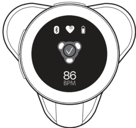
Si les électrodes entrent en contact avec la peau, les indicateurs de dérivation deviennent verts. Le tracé ECG fictif entre les deux électrodes supérieures montre que la forme d'onde en temps réel affiche l'ECG à l'écran lorsqu'elle est active.
